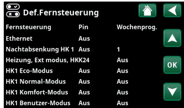
Ausschnitt aus dem Menü „Fachmann/Definieren/Fernsteuerung“. Hier werden „Eingang“ und „Wochenprogramm“ festgelegt.
