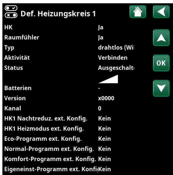
Menü: „Fachmann/Definieren/Heizkreis/Heizkreis 1“ Drahtloser Raumfühler ausgewählt.
