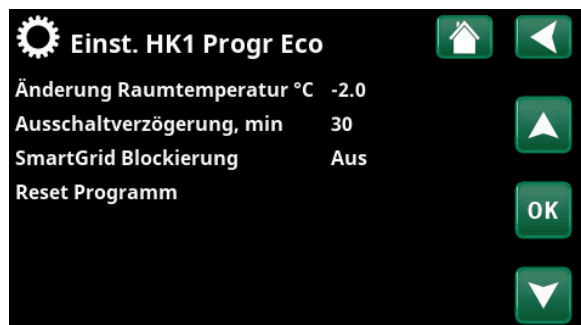
Menü „Fachmann/Einstellungen/Heizkreis/Heizkreis 1/Programm/Eco“.
